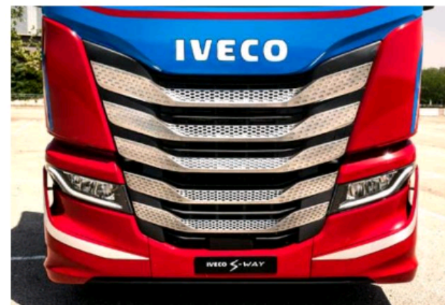
De bumper uit drie delen maakt het mogelijk slechts het beschadigde gedeelte te vervangen.
